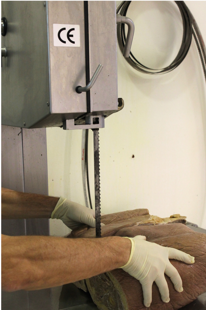
Figura 25. Sierra utilizada para la sección de las pelvis. Modelo Mado Selekt 3. En la imagen se muestra la técnica de sección de la pelvis formolizada en el plano medio sagital.
