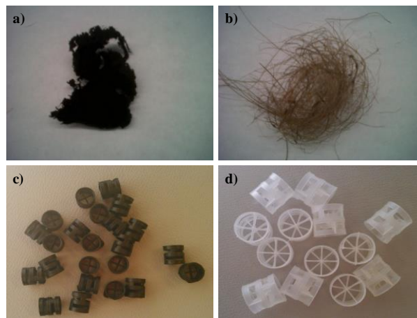
Figura 4.7. Detalle de diferentes materiales de relleno utilizados. Rellenos orgánicos: a) Turba fibrosa; b) Fibra de coco. Rellenos inertes: anillos de polipropileno: c) 16 mm; d) 25 mm.
