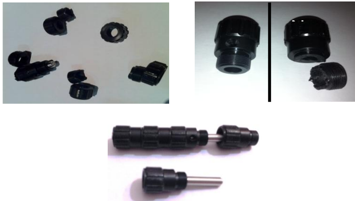
Figura 8.3. Piezas deterioradas del sistema POPLink.
