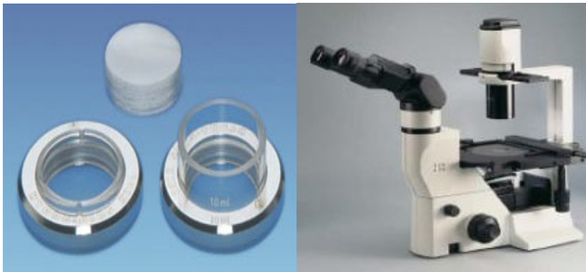
Figura 2.4. Material para la observación del zooplancton. Cámara Utermöhl tubular de sedimentación de plancton y microscopio óptico invertido (Modelo Olympus CK2).
