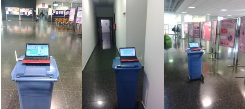
Imagen 33: Medición de Fingerprints mediante antena externa conectada mediante USB
