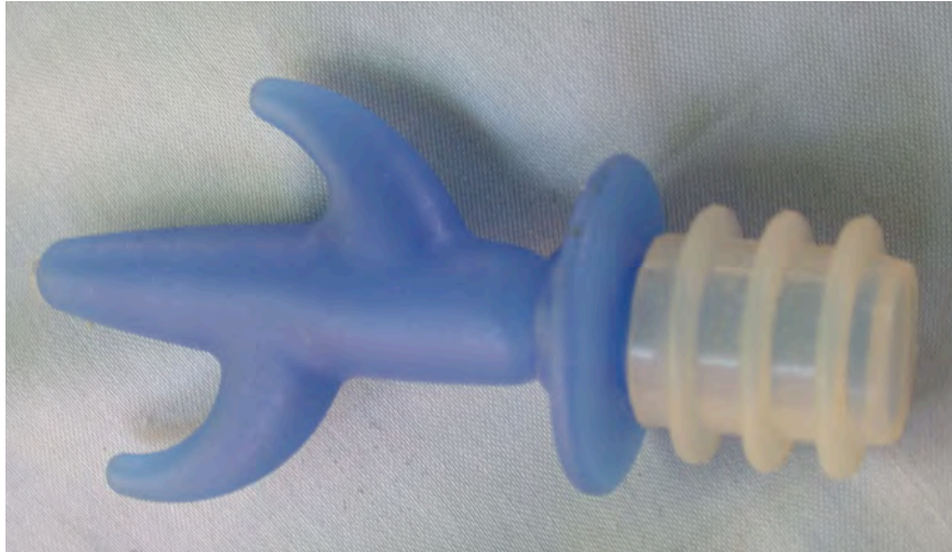
Fotografía nº 45.-Tapón de conservación con cabeza de plástico.
