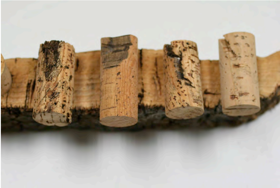
Fotografía nº 49.- Diferentes tapones defectuosos.
