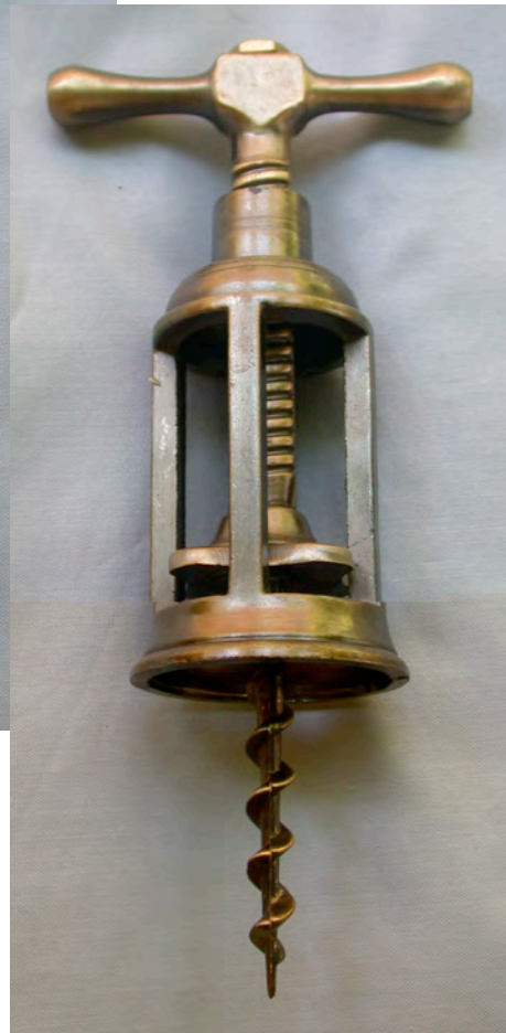
Fotografía nº 98.- Sacacorchos de torniquete con apoyo en aro acoplado al cuello de la botella.
