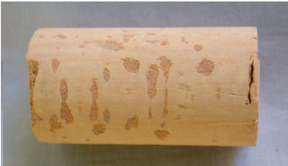
Fotografía nº 36.- Tapón de corcho colmatado.
