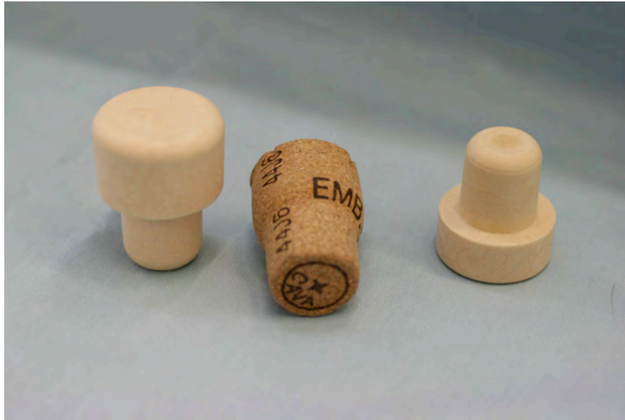
Fotografía nº 44.- Comparación de tapones cabeza sintéticos y de partículas de corcho.
