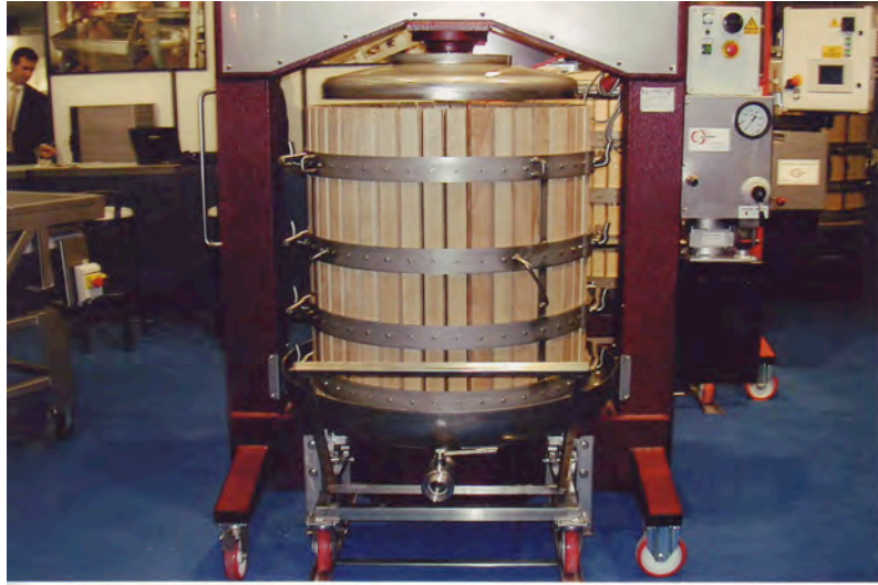
Fotografía nº 54.- Moderna prensa vertical de obtención de mosto.
