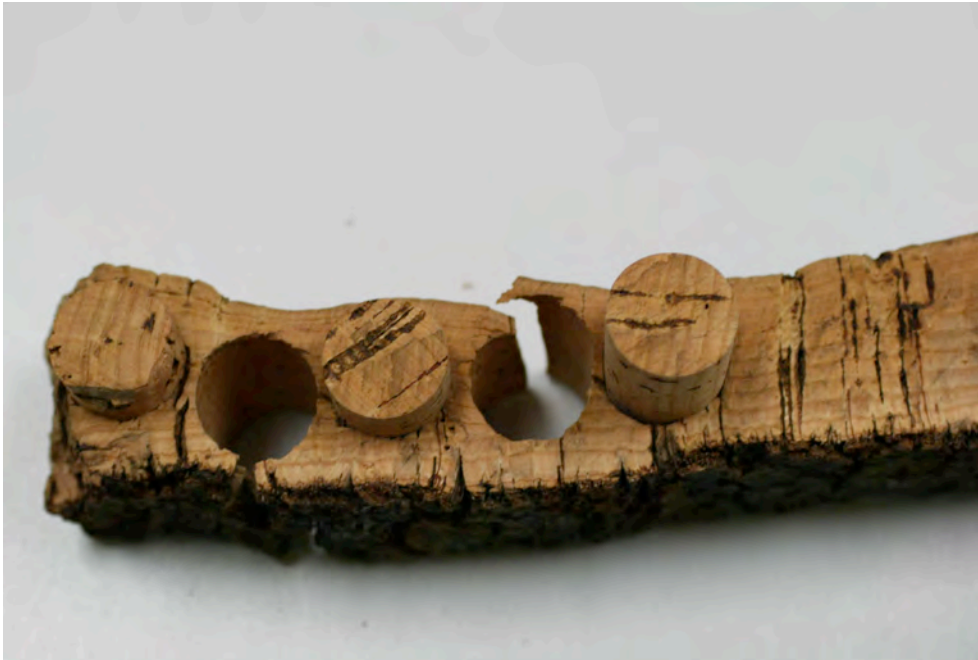
Fotografía nº 32.- Plancha de corcho tras pasar por el cilindro marcador.
