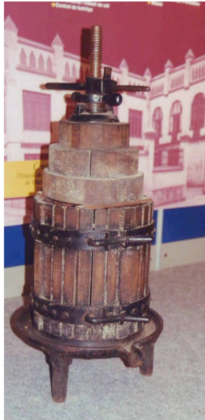
Fotografía nº 53.- Prensa vertical utilizada hace tiempo en bodega.
