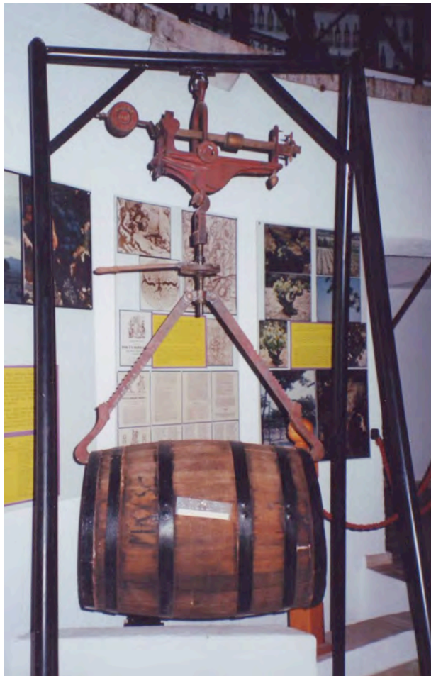
Fotografía nº 31.- Antigua balanza y sistema de alzado de barricas.
