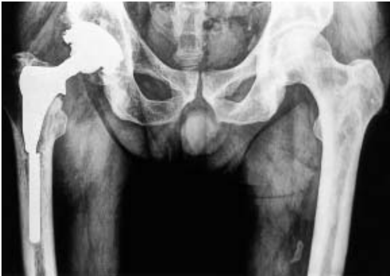
Figura 5. La radiografía, correspondiente al caso número 3, muestra la fractura del componente femoral protésico a nivel de la unión metafiso-diafisaria asociada a una osteolisis de la parte proximal.
