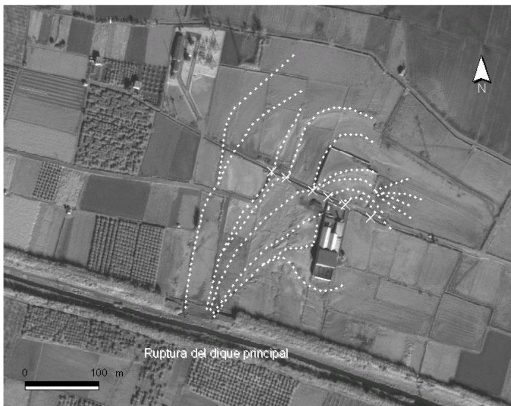
Figura 4. Detalle de la imagen Ikonos mostrando la interpretación del derrame número 3. Ruptura del dique y dirección del derrame hacia la llanura. Las cruces indican las pequeñas rupturas en los límites del parcelario.
