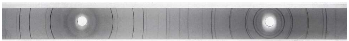
Aspecte real d'un film de Debye-Scherrer
