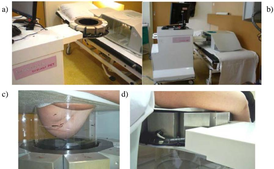
*Figura 27. Imágenes del detector MAMMI. a) Anillo detector. b) Carcasa en la que se sitúa la electrónica y camilla especialmente diseñada para posicionar a la paciente. c) Posición de la mama al realizar un escáner. d) Posicionamiento de la paciente durante el escáner.*
