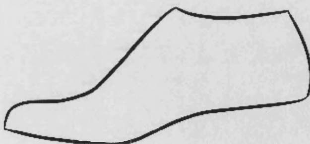
Figura 25: Elevación de la puntera y trasera que debe proporcionar la horma (Ramiro y cols., 1995).
