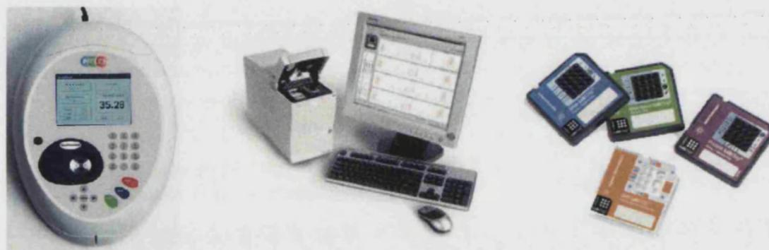
**Figura 3.12** Nanofotómetro (NanoPhotometer™, a la izquierda) y Bioanalizador Agilent 2100 junto con los chips.
