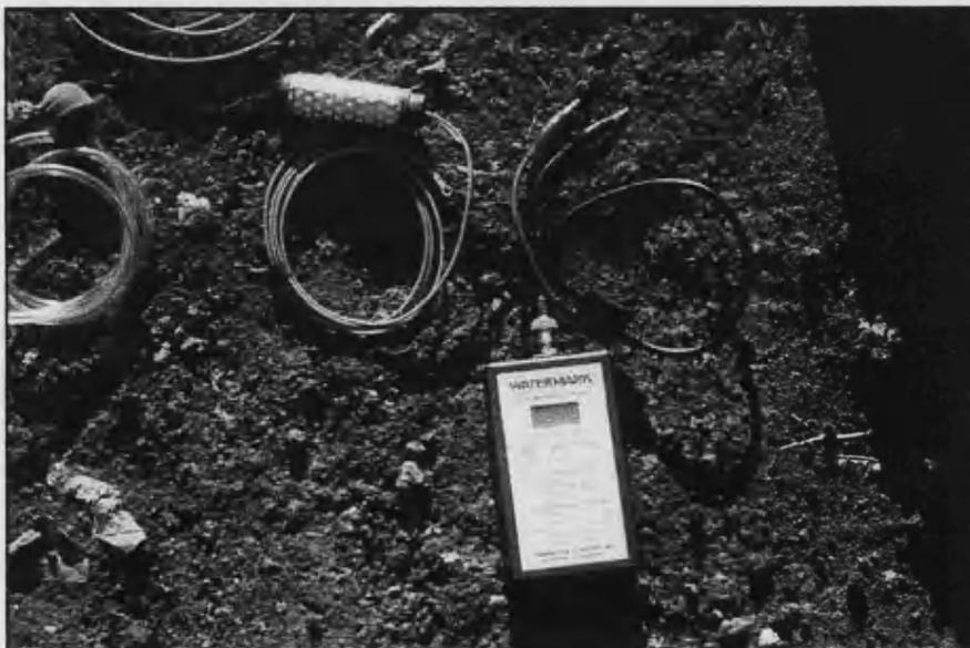
Foto 2. Dispositivos de monitorización (detalle del tensiómetro)
