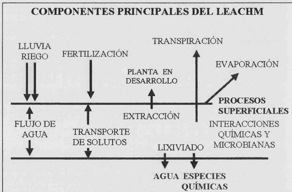
Figura. 2.4. Esquema de los componentes principales y rutinas descritas en el LEACHM
