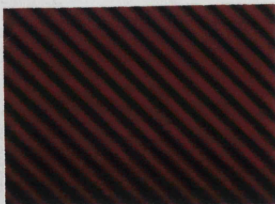
Fig. 5-3. Con una red fuente de período d''=0'57mm girada 45^\circ respecto a la vertical se obtiene, en el plano correspondiente a los resultados de la Fig.5-2, un patrón de franjas de perfil triangular.
