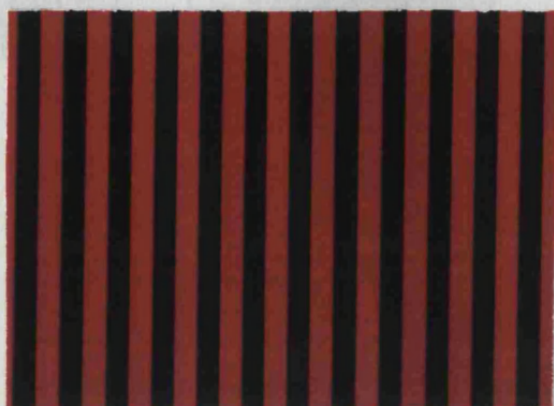
Fig. 4-5. Con la red fuente indicada en la Fig.4-4, y una red objeto de fase, binaria y de salto de fase \pi/2 , de período d=0.253\text{mm} se puso en consonancia el patrón de índice Q'+q'=1/4 . Las distancias z y R eran z=1601\text{cm} y R=739\text{cm} . Obsérvese la gran similitud de este patrón con las franjas de Lau de la Fig.4-4a.
