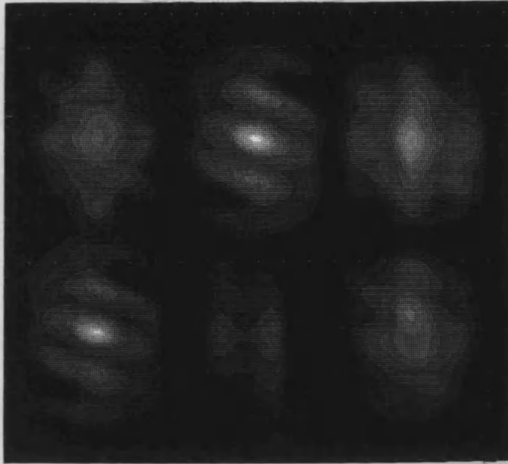
Fig. 5-11. Representación en niveles de gris del resultado teórico de la correlación de las señales empleadas en el experimento.
