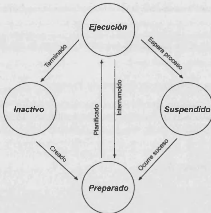
Figura 7.12: Forma general del diagrama de transición de estados.
