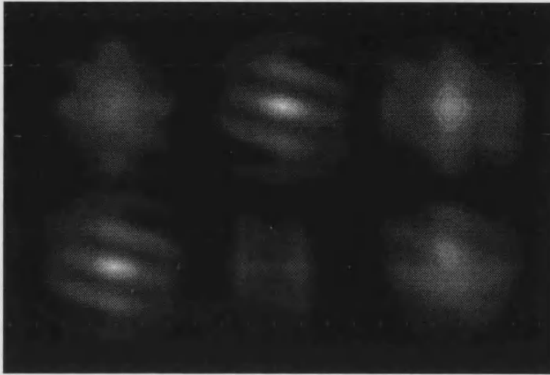
Figura 3.10. Representación en niveles de gris del cálculo numérico de la correlación entre las señales de entrada y referencia utilizadas en la experiencia de reconocimiento de caracteres. Nótese la gran similitud con el resultado obtenido ópticamente con el dispositivo propuesto, presentado en la fig. 3.9.
