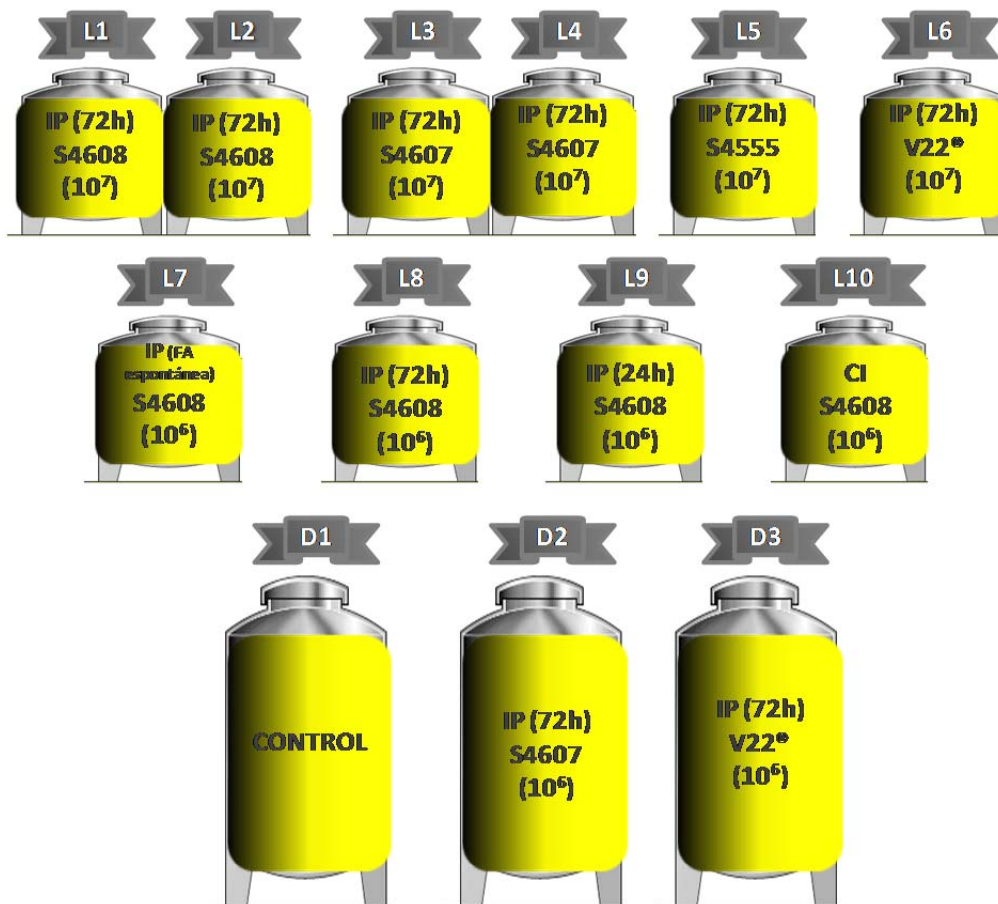
Figura 8. Esquema de las vinificaciones semiindustriales en blanco realizadas en Laboratorios Excell Ibérica en 2010 (IP: inoculación previa de las BL, CI: coinoculación, 10^6 - 10^7 : concentración de inóculo en células/mL).
