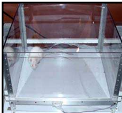
Figura 12. Jaula para medir actividad motora.
