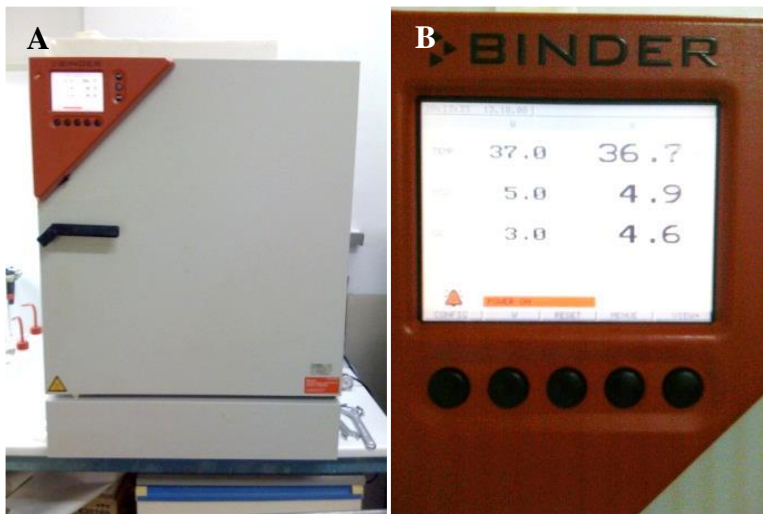
Figura 5.3. A y B: Estufa de cultivo celular. Condiciones: 37°C, 5% de CO 2 y 3% de O 2 .
