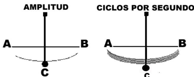
Fig. 3: Movimiento oscilatorio de un péndulo ejemplificando la amplitud y la frecuencia de vibración.
