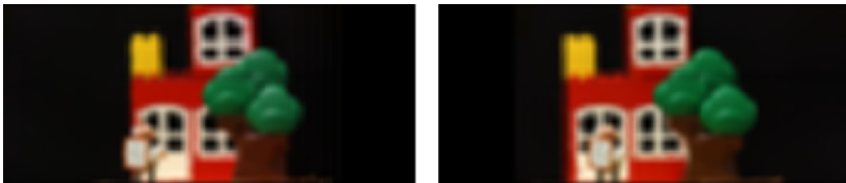
Fig. 54. Resultado de la simulación del proceso de visualización de la escena 3D reconstruida con g_R = -f' . Las dos perspectivas corresponden a un observador monocular, situado a una distancia L = 500 mm de las microlentes, que se desplaza a dos posiciones laterales distintas. El plano de visualización coincide con el plano del muñeco.
