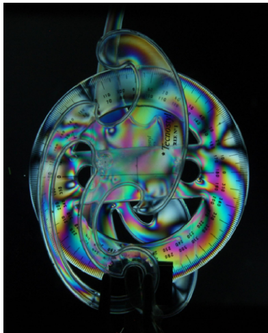
Fig. 100. Conjunto de tres herramientas de dibujo, con oclusiones mutuas, bajo el análisis de un polariscopio plano convencional.
