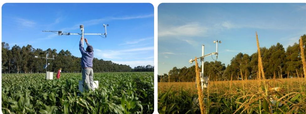
Figura 3.1. Estaciones de balance de energía en el cultivo de maíz: a) instalación de sensores en la etapa de desarrollo del cultivo (izquierda) y b) el cultivo en su etapa de floración (derecha).
