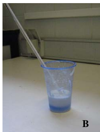
Figura 2. Fluido dilatante (suspensión altamente concentrada de almidón).
