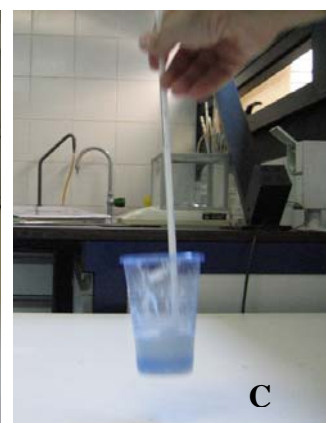
Figura 2. Fluido dilatante (suspensión altamente concentrada de almidón).
