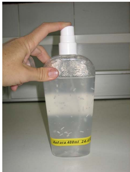
Figura 1. Frasco de fluido pseudoplástico, con pulverizador (gel de bentonita con pequeños plásticos en suspensión).
