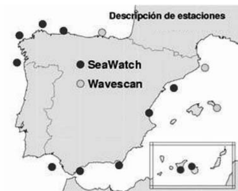
Figura 13. Localización de las boyas de la red de aguas profundas gestionada por Puertos del Estado. Hay dos clases de boyas: Sea Watch y Wavescan (Fuente: Puertos del Estado)
