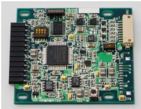
Figura 3.6 Fotografía del integrador de carga Hamamatsu C9118-01 para control externo de la matriz S8866-128-02 (izquierda) y esquemático de cómo realizar la conexión en cascada de dos o más de estos dispositivos (derecha); se observa cómo se necesita un solo controlador externo para el conjunto.
