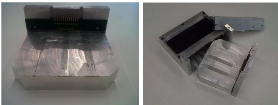
Figura 3.2 Detalle del prototipo de hodoscopio del IN2P3. A la izquierda se observan las fibras encaradas con la posición del fotodiodo correspondiente en la matriz. A la derecha las distintas piezas que componen el sistema.
