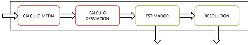
Figura 6.4 Secuencia de operaciones para resolución del EMV. Primero se realiza el cálculo de la media y la resolución, para posteriormente llevar a cabo la estimación de la posición de interacción y el cálculo de su error, es decir, la nueva resolución.
