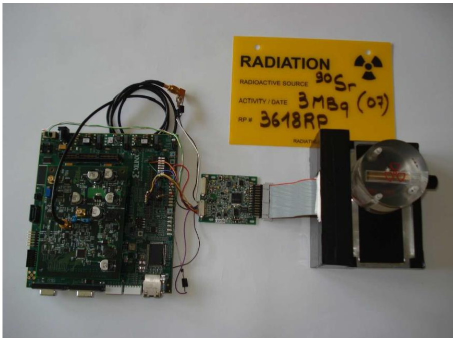
Figura 3.14 Primer banco de pruebas con fuente 3618RP Sr-90 (3 MBq) colocada sobre el prototipo. En la figura se observa el montaje detector más read-out, así como la fuente utilizada.
