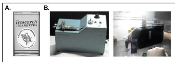
**Figura 25.** El EHT generado fue utilizado como estímulo en los experimentos *in vitro*. A. Cigarros de investigación 2R4F utilizados en los experimentos. B. Bomba de respiración de animales utilizada para generar el EHT y burbujearlo en el medio de cultivo.
