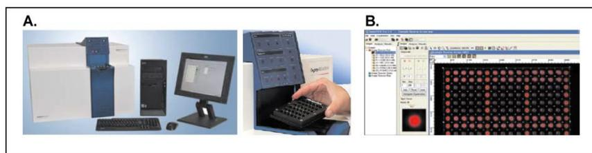
**Figura 33. Lectura de la fluorescencia y análisis de resultados.** A. Lectura de la fluorescencia de los chips con el aparato *ZeptoREADER™*. B. Las imágenes de los chips fueron almacenadas como archivos TIFF (16-bit) y analizadas con el software *ZeptoView™ Pro* (versión 2.0, Zeptosens).
