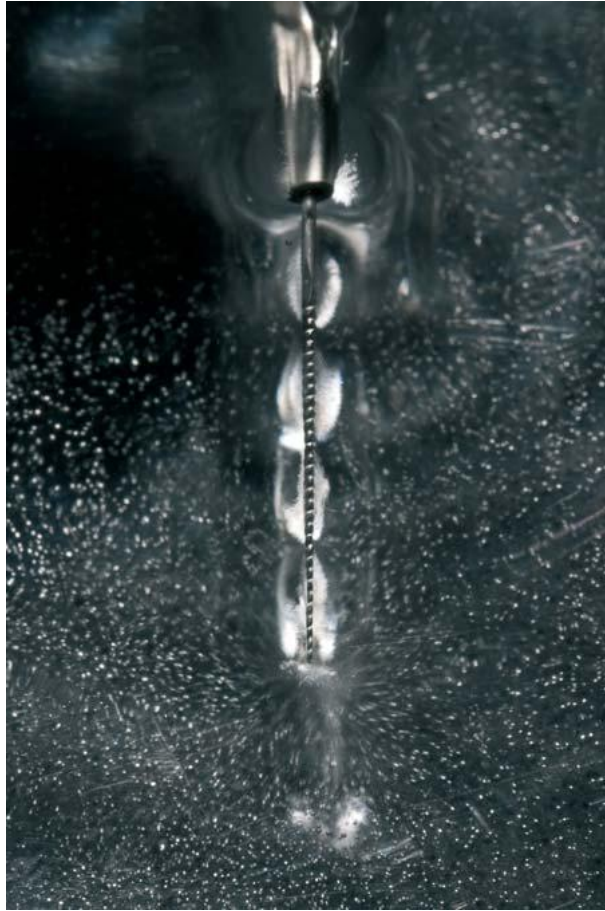
Fig. 3 (Imagem, gentilmente cedida por Prof. van der Sluis, do streaming acústico fluindo em torno de uma lima em água livre.)
