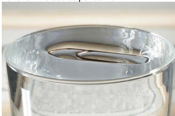
Figura 5.1b. Si el clip no exerceix suficient treball, no es trencarà la superfície de l'aigua. El clip és d'acer i no està surant.
