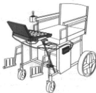
Figura 24. Ejemplo de acoplamiento de un ordenador portátil a una silla de ruedas con motor.
