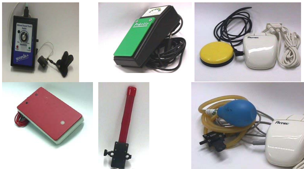
Figura 17. Ejemplos de conmutadores utilizables para selección por barrido (Para más información sobre conmutadores consultar la base de datos Ayteca ( http://acceso.uv.es )).
