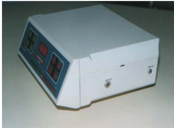
Figura. 4. Electromiógrafo marca Mioback adaptado con un rele para ser utilizado con niños.
