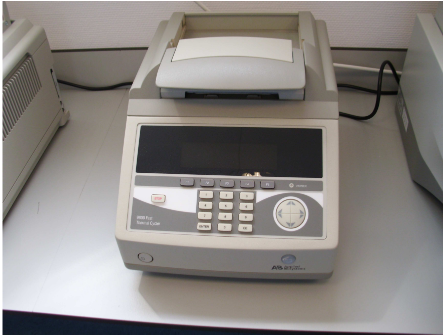
Figura 17. Termociclador 9800 Fast Thermal Cycler donde se llevó a cabo la retrotranscripción de ARN en ADNc.
