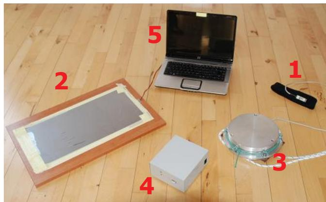
Imagen 10. Representa las partes por las que está formado el sistema de adquisición de datos. 1. Led (azul-rojo) que da la señal de inicio; 2. Plataforma de contacto; 3. Plataforma de fuerza; 4. Microcontrolador; 5. PC.
