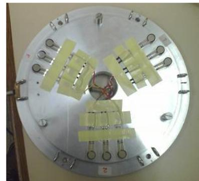
Imagen 12. Disposición de los sensores en la plataforma de fuerzas.
