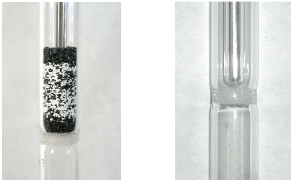
Figura 3.3.2 – Detalle del reactor con y sin el lecho catalítico
