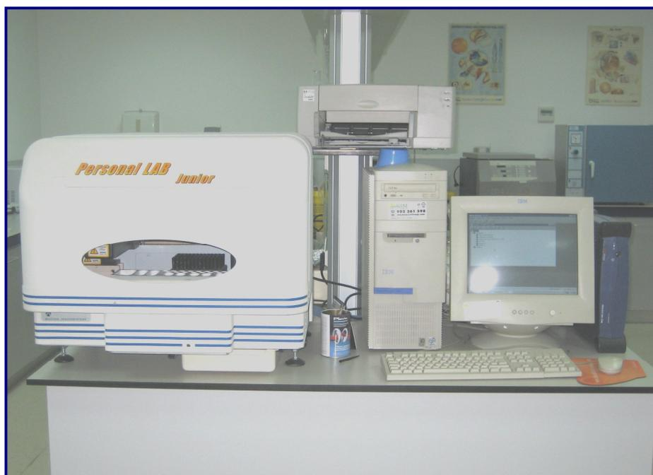
*Fig 34.- Personal Lab Junior utilizado en la determinación del Óxido Nítrico*
