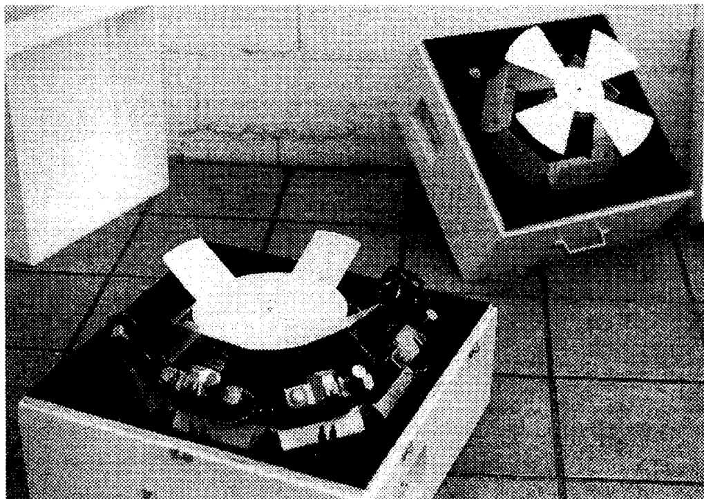
Figura 2.3. - Dos de las cuatro baterías construidas. En cada estación fotográfica estas dos baterías complementarias registran todo el cielo hasta una altura sobre el horizonte de 25^\circ . En el fondo la batería que registra el cenit y en primer plano la que cubre la región a media altura.
