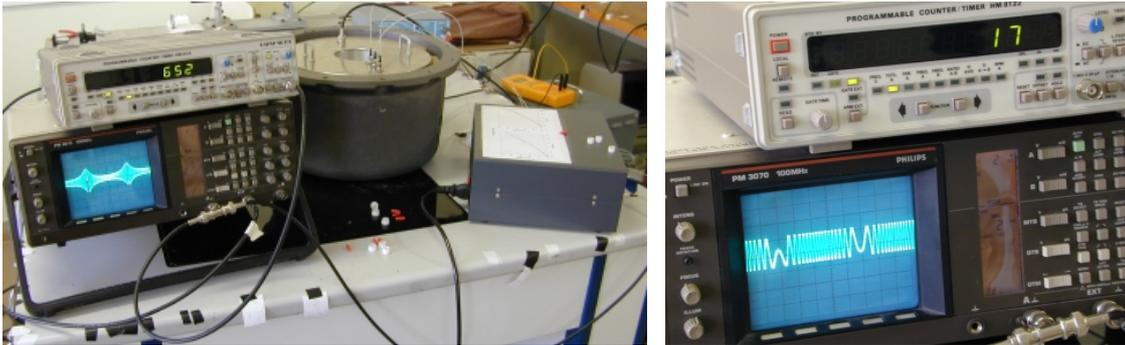
Figura 4.2. Sistema de medida del número de franjas generado por semiperíodo.
