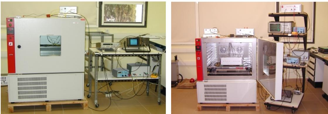
Figura 5.3. Cámara térmica y dispositivos de medida.
