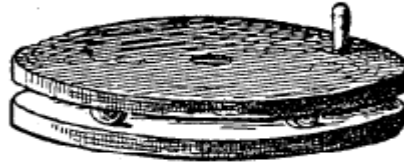
Aparato para producir las trepidaciones sacudidas originadas por la marcha de un tren
