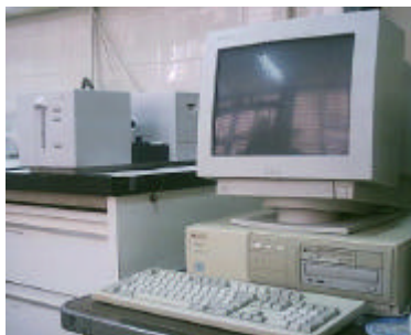
Figura 20. Espectrofotómetro de fila de diodos UV-vis HP 8452 conectado a un PC Hewlett Packard Vector XM 5/90.
