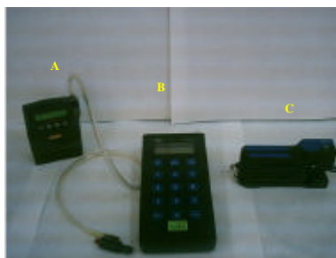
Figura 17. (A) Bomba de aire, (B) Medidor de flujo y (C) Bomba de detección de gases
