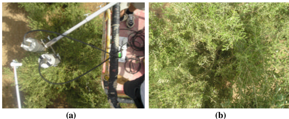
FIGURA 6.5 a) Montaje de los radiómetros CIMEL en la grúa utilizada para realizar las medidas de emisividad sobre olivos y b) vista desde la grúa de la copa del olivo.
