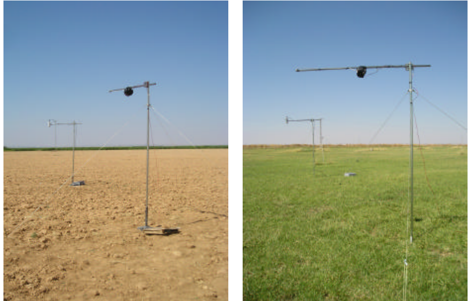
FIGURA 6.8 Mástiles utilizados para realizar medidas de temperatura radiométrica en zonas de suelo desnudo (izquierda) y hierba (derecha).
