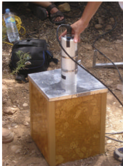
FIGURA 6.7 Caja pequeña y radiómetro CIMEL CE 312-2 ASTER sobre la zona de suelo correspondiente a la zona de olivos.
