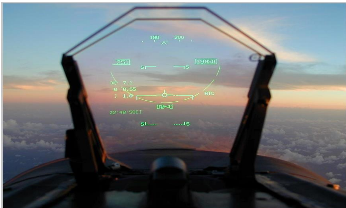
Rys. 8.6. Jedno z pierwszych zastosowań systemów AR - wyświetlanie informacji na szybie w myśliwcu.
