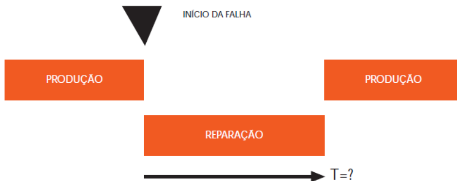
Figura 2.8 – Paragem não programada, devido a avaria. [10]
