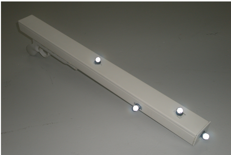
Figura 50 – Interface de jogo com marcadores do sistema Vicon.
