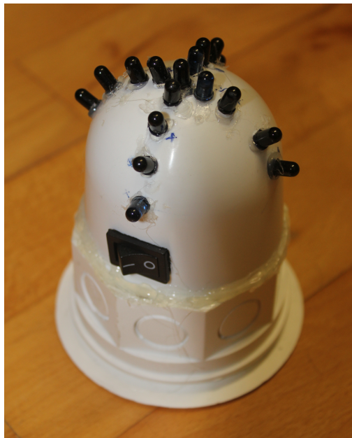
Figura 45 – Fotografia do sistema de leds infravermelhos montados com uma organização semiesférica.
