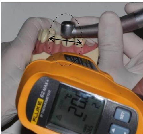
*Figura 1 - Pontos de medição termómetro Fluke 62MAX+*
