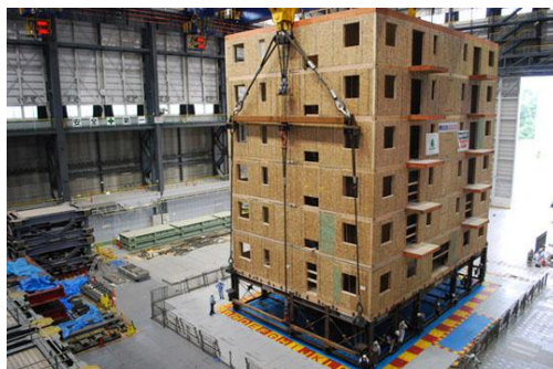
Figura 4-25 Ensaio dinâmico num edifício (LNEC)
