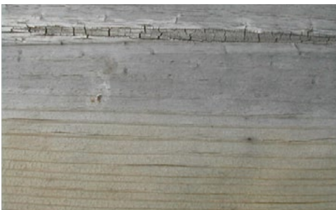
Fig. 2 - Perda de cor natural da madeira ao fim de um ano no exterior descoberto.
