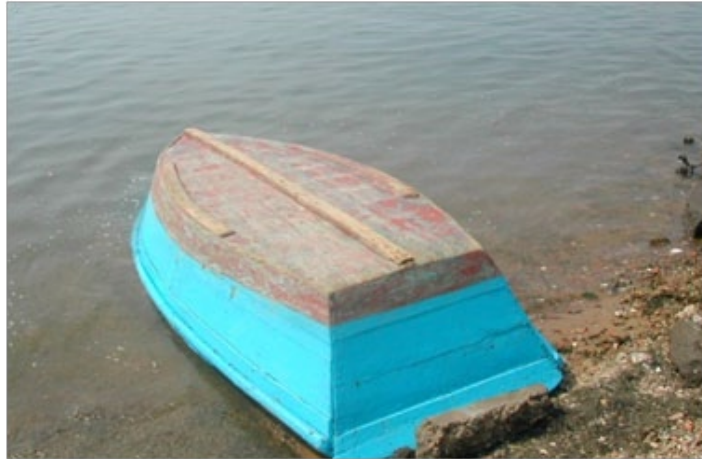
Fig. 13 - Necessidade de proteção do fundo e costado inferior de uma pequena embarcação.
