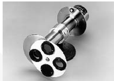
Pirheliómetros: Eppley NIP, à direita; Kipp & Zonnen CHP 1, à direita.
