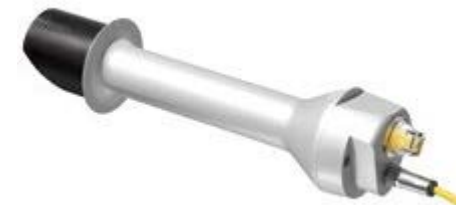
Pirheliómetros: Eppley NIP, à direita; Kipp & Zonnen CHP 1, à direita.
