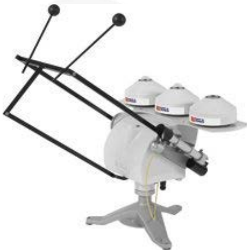
Exemplo de montagem de piranómetros e piriómetros num sun tracker (Kipp & Zonnen Solys 2). Três piranómetros estão sobre a plataforma, com discos de ocultação em dois deles; um piriómetro está montado do lado direito da imagem (ou lado esquerdo apontando para o Sol).
