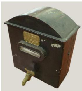
Figura 6. Contador (hidrómetro) fabricado por Pinto Bastos em meados das décadas de 1880-1890, nas oficinas da Companhia das Águas de Lisboa. Cortesia do Museu da Água, EPAL (inv. MDA.00410).
