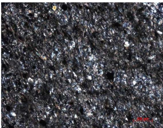
Fig.8 – Aspecto microscópico do xisto de Nozelos, NX.
