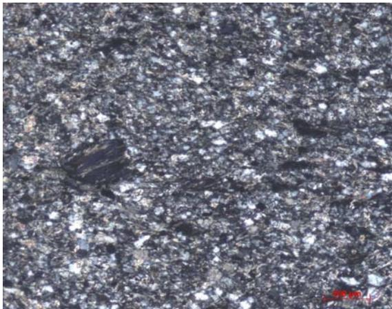
Fig.7 – Aspecto microscópico do xisto da Eucísia, NX.
