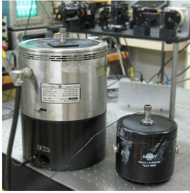
Figura 4 – Excitador Bruel & Kjaer , modelos 4812 (esquerda) e 4809 (direita).
