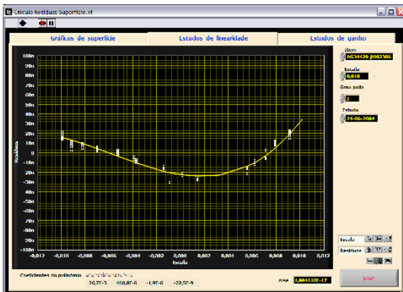
Figura 5 – Painel frontal do módulo do cálculo de linearidades, que permite seleccionar o grau de polinómio de ajuste.
