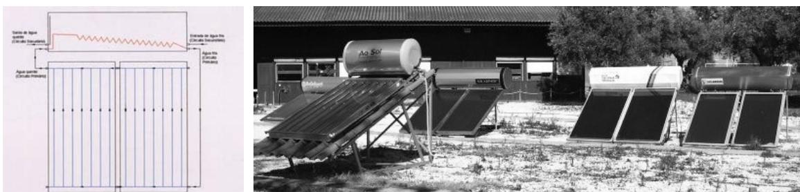
**Figura 1 - Esquema hidráulico do sistema de referência e apresentação de alguns sistemas habitualmente utilizados em Portugal.**
